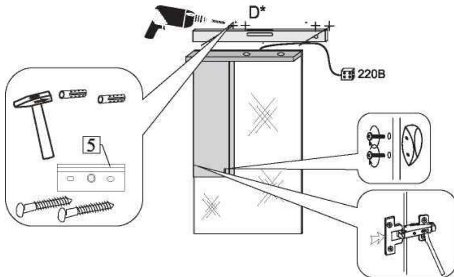
D\* — диаметр отверстия зависит от диаметра дюбеля
